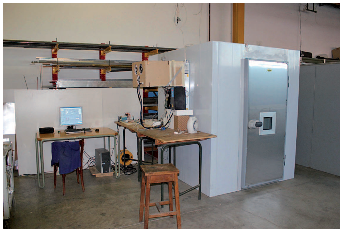
Figura 1 - La simulazione in laboratorio degli stress che può subire un prodotto, nel passaggio dal produttore al consumatore con l'obiettivo di riprodurli sul prodotto non stressato, a scopo di studio
