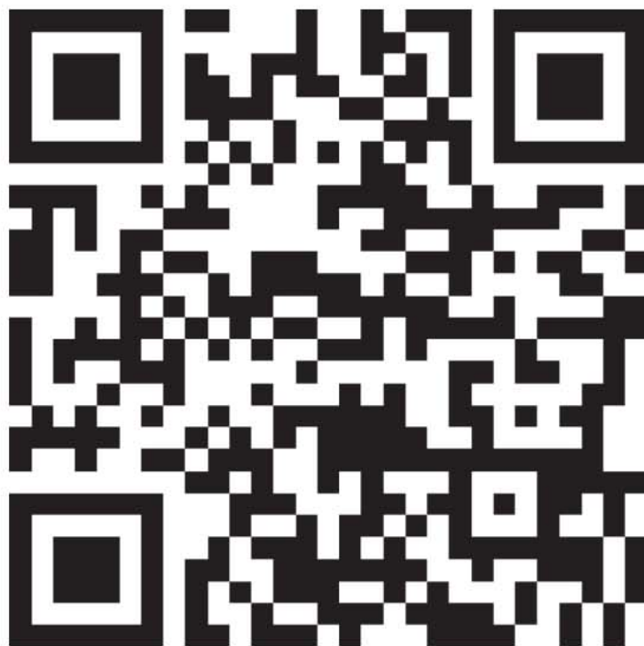
Il codice QR, Quick Response, concepito dalla giapponese Denso Wave, abbina capacità di dati a rapida decodifica grazie ai "position detection pattern" che ne individuano l'orientamento indipendentemente dall'angolo di scansione
