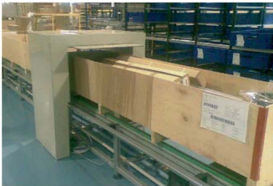
SLIMPA-KONE ha implementato un progetto pilota nell'area di imballaggio finale. Sopra, il gate di lettura dei pacchetti elettrici in area di imballaggio finale, configurato secondo quanto indicato nel disegno a destra
